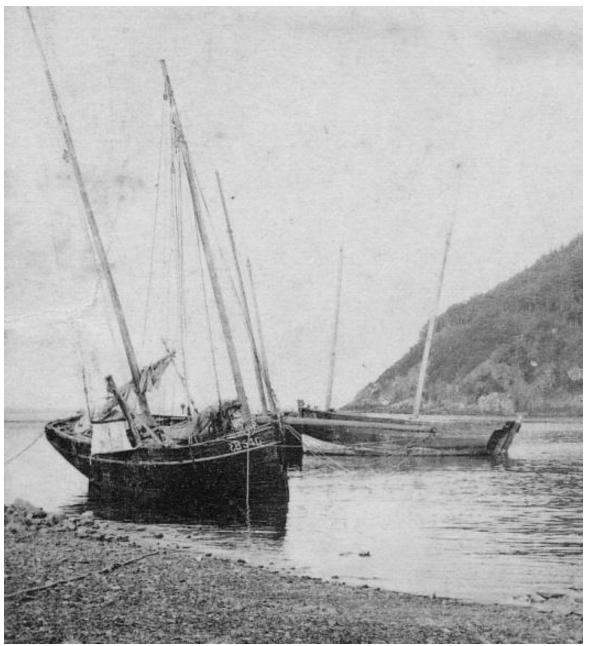
Sur ce détail d'une cette carte postale ancienne, sur le lougre à l'arrière-plan on voit bien le prolongement du tableau d'une trentaine de centimètres formant une sorte de coffre d'une trentaine de centimètres de hauteur également, l'étambot semble doublé à l'extérieur du tableau et le gouvernail reste à l'extérieur du tout, le lougre au premier plan ne semble pas avoir ce type d'extension on y vois bien sa potence de drague ainsi que la drague suspendue avec son sac en forte toile
